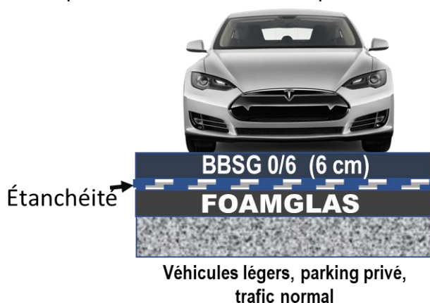
Fig. 5-b : Schéma de principe des différentes couches d'enrobés bitumineux
