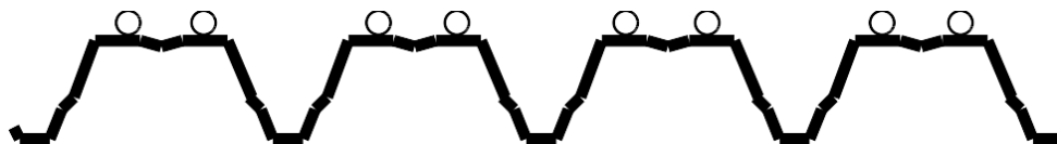
Figure 8 : schéma de principe disposition des cordons de colle PC® 11
