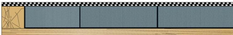
Figure 7c – Coupe de principe sur rive avec butée en bois, sur élément porteur bois - panneaux à base de bois
