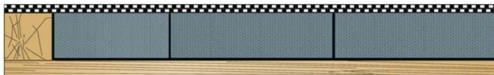
Figure 10c – Coupe de principe sur rive avec butée en bois, sur élément porteur bois - panneaux à base de bois
