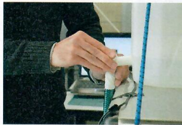
Figure 13 – Fase di montaggio della configurazione per il test di tenuta all'acqua
