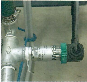
b) Manometro (Gefran TK-E-1-E-B16U-H-V con precisione \pm 0.25\% FSO) per il monitoraggio della pressione all'interno della camera
