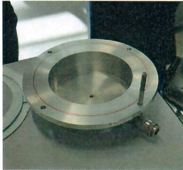
a) Camera pressurizzata riempita con acqua.
