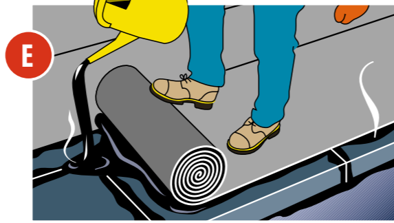
Eksempel på utlegging av hellimt tettesjikt.
