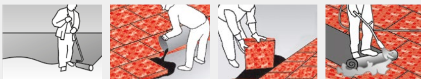
FOAMGLAS® READY geklebt mit Kaltkleber PC® 58
