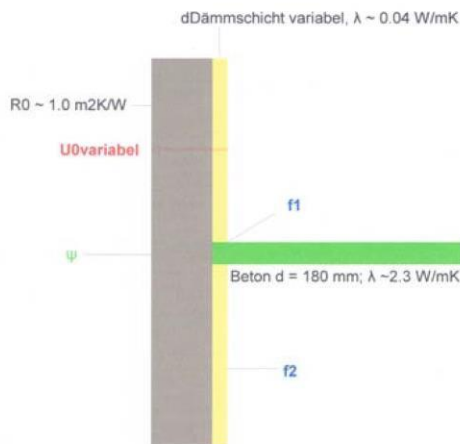
Bild 1: Schemaschnitt Wärmebrücke mit Festlegungen
