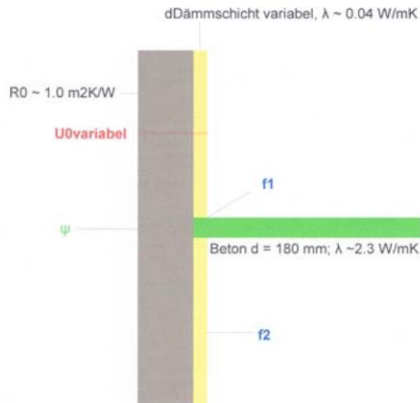
Bild 1: Schemaschnitt Wärmebrücke mit Festlegungen
