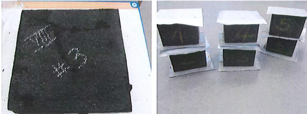
Abbildung 3: Probe bei Ankunft in den FIW-Laboren (links), Proben zur Messung der Druckfestigkeit (rechts).
