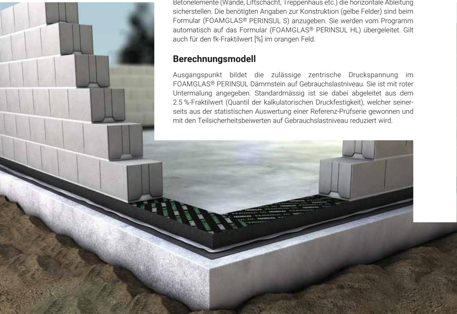
**FOAMGLAS® PERINSUL S** für den wärmegeädämmten Mauerfuss
