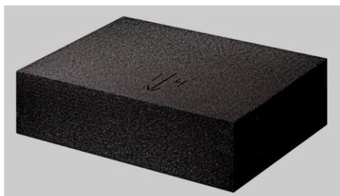
FOAMGLAS® TAPERED T4+ est une plaque à pente intégrée composée de verre cellulaire FOAMGLAS® T4+. La direction de la pente est indiquée par une flèche, les plaques sont spécialement repérées et numérotées.
