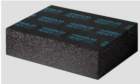
FOAMGLAS® READY TAPERED T3+ besteht aus FOAMGLAS® READY T3+, welches entlang der Quer- bzw. Längsachse ein Gefälle aufweist. Ein Pfeil zeigt die Richtung des Gefälles an. Oberseitig ist eine Bitumenbeschichtung mit PE-Folienkaschierung aufgebracht. Diese ist zum Aufschweißen von Bitumenbahnen geeignet.
