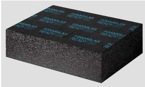
FOAMGLAS® READY TAPERED T3+ besteht aus FOAMGLAS® T3+, welches entlang der Quer- bzw. Längsachse ein Gefälle aufweist. Ein Pfeil zeigt die Richtung des Gefälles an. Oberseitig ist eine Bitumenbeschichtung mit PE-Folienkaschierung aufgebracht. Diese ist zum Aufschweißen von Bitumenbahnen geeignet.
