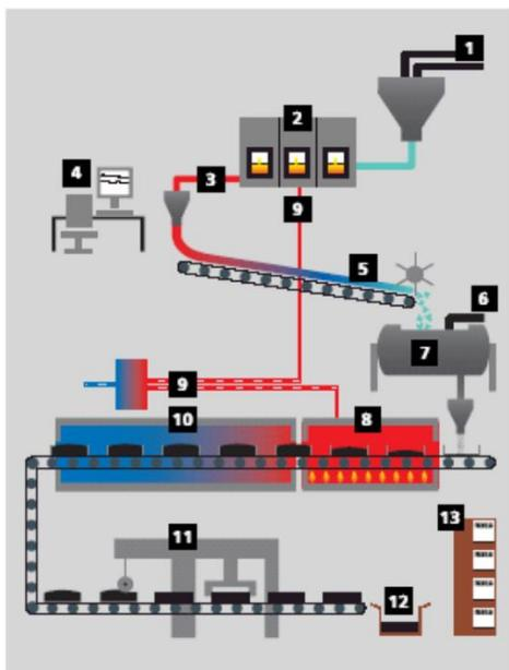
1. Adjonction et dosage des composants : verre recyclé, feldspath, oxyde de fer, oxyde de manganèse, sulfate de sodium, nitrate de sodium.
