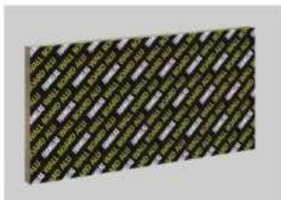
FOAMGLAS® WALL BOARD ALU T3+ est un panneau de format 1200 x 600 mm composé de plaques de verre cellulaire FOAMGLAS® T3+ assemblées entre elles. Le côté supérieur du panneau est revêtu d'une feuille en alu (4 µm et couleur en noir avec print en jaune). La face en dessous est revêtu d'un non-tissé en verre minéralisé en blanc.
