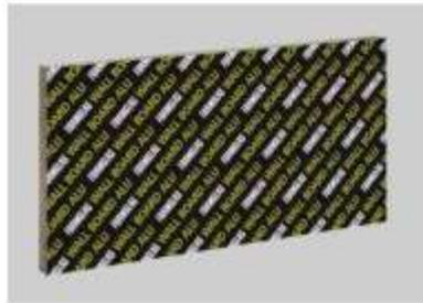
FOAMGLAS® WALL BOARD ALU W+F est un panneau de format 1200 x 600 mm composé de plaques de verre cellulaire FOAMGLAS® W+F assemblées entre elles. Le côté supérieur du panneau est revêtu d'une feuille en alu (4 µm et couleur en noir avec print en jaune). La face en dessous est revêtue d'un non-tissé en verre minéralisé en blanc.
