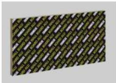
FOAMGLAS® WALL BOARD ALU T4+ est un panneau de format 1200 x 600 mm composé de plaques de verre cellulaire FOAMGLAS® T4+ assemblées entre elles. Le côté supérieur du panneau est revêtu d'une feuille en alu (4 µm et couleur en noir avec print en jaune). La face en dessous est revêtue d'un non-tissé en verre minéralisé en blanc.
