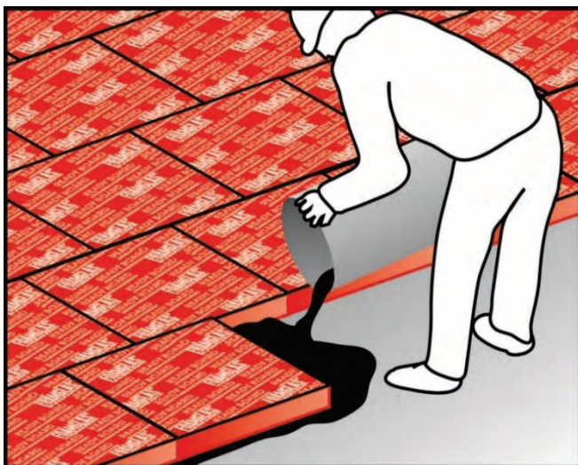
Figure 2a – Pose de la plaque isolante, verser la colle sur le support
