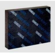
FOAMGLAS® READY BLOCK T3+ est un panneau composé de verre cellulaire FOAMGLAS® T3+. La face supérieure du panneau est pourvue d'un revêtement spécial bitumé, qui permet de poser des lés d'étanchéité par soudure.
