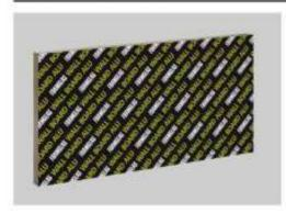
FOAMGLAS® WALL BOARD ALU T3+ est un panneau de format 1200 x 600 mm composé de plaques de verre cellulaire FOAMGLAS® T3+ assemblées entre elles. Le côté supérieur du panneau est revêtu d'une feuille en alu (4 µm et couleur en noir avec print en jaune). La face en dessous est revêtue d'un non-tissé en verre minéralisé en blanc.
