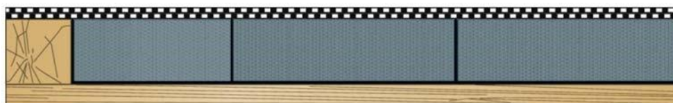
Figure 10c – Coupe de principe sur rive avec butée en bois, sur élément porteur bois - panneaux à base de bois
