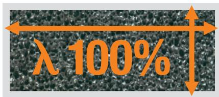
Diese positiven bauphysikalischen Eigenschaften wurden mit Einführung der Energieeinsparverordnung auch rechnerisch relevant. Foamglas behält in jedem Abdichtungsaufbau seine Wärmeleitgruppe bei und muss nicht mit Korrekturfaktoren für Luftspalte und Befestiger abschlägig berechnet werden (DIN EN ISO 6946, Anhang D).
