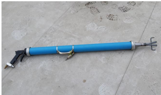
Pompe K4 avec buse double sortie (fournisseur : DERBIGUM FRANCE)
