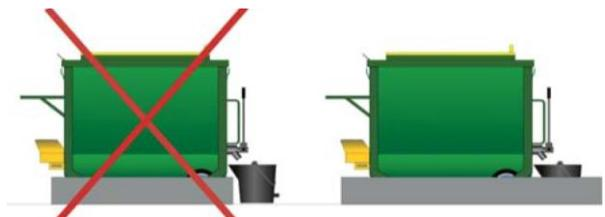
Lors du soutirage du bitume, le récipient verseur doit être posé dans le bac de rétention et le préposé ne doit pas avoir à le tenir lors de son remplissage.
