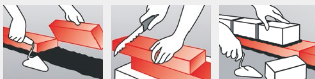
FOAMGLAS® PERINSUL, élément d'isolation porteur sous maçonnerie
