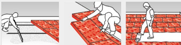
Panneaux FOAMGLAS® Boards, posés à sec
