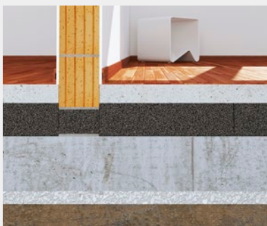
FOAMGLAS® TAPERED ROOF SYSTEM (Système d'isolation avec pentes intégrées), FOAMGLAS® PERINSUL (Elément d'isolation thermique porteur sous maçonnerie)
