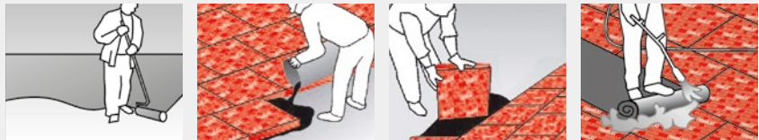
FOAMGLAS® READY geklebt mit Kaltkleber PC® 58
