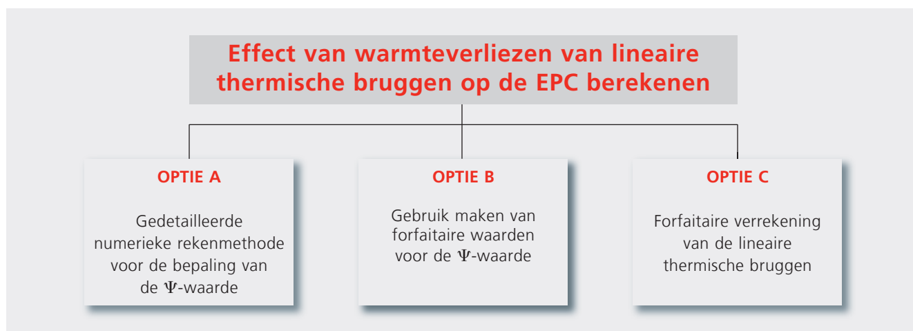
Schema met de opties om lineaire warmteverliezen mee te rekenen in de EPC-berekening
