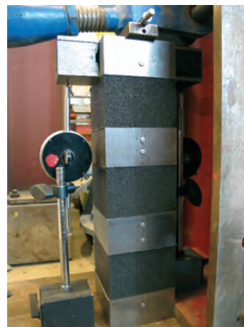
Figuur 4: Kruipproeven op FOAMGLAS® PERINSUL-blokken
