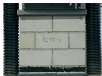
Figuur 5: Drukproef op gemetseld muurtje van kalkzandsteen met koudebrugonderbreking
