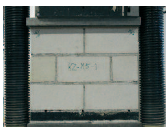
Figuur 5: Drukproef op gemetseld muurtje van kalkzandsteen met koudebrugonderbreking
