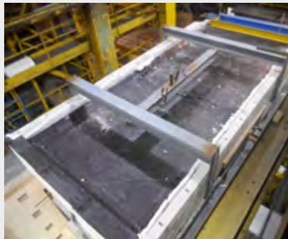
Paroi non exposée avant l'essai
