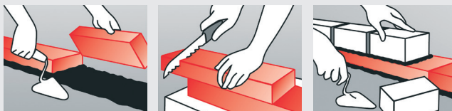
FOAMGLAS® PERINSUL Tragendes Wärmedämmelement für Mauerwerk
