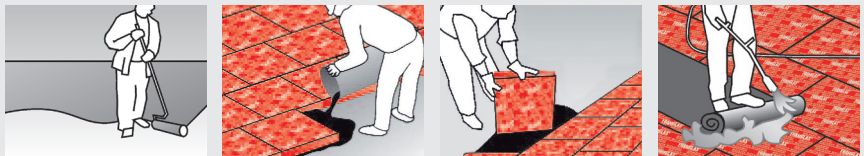
FOAMGLAS® Blocks geklebt mit Kaltkleber (PC® 58 oder PC® 500)
