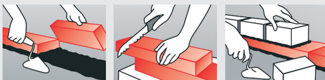
FOAMGLAS® PERINSUL, elemento termoisolante portante per opere murarie
