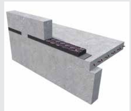
Sous acrotère (pose en peigne)
