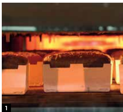
1 Moule dans le four de moussage 2 Bloc de verre cellulaire à la sortie du four de moussage
