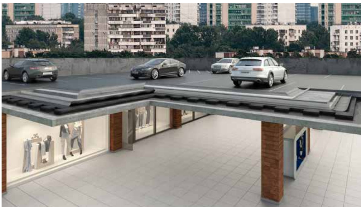
Image 3D de la structure d'une toiture-parking
