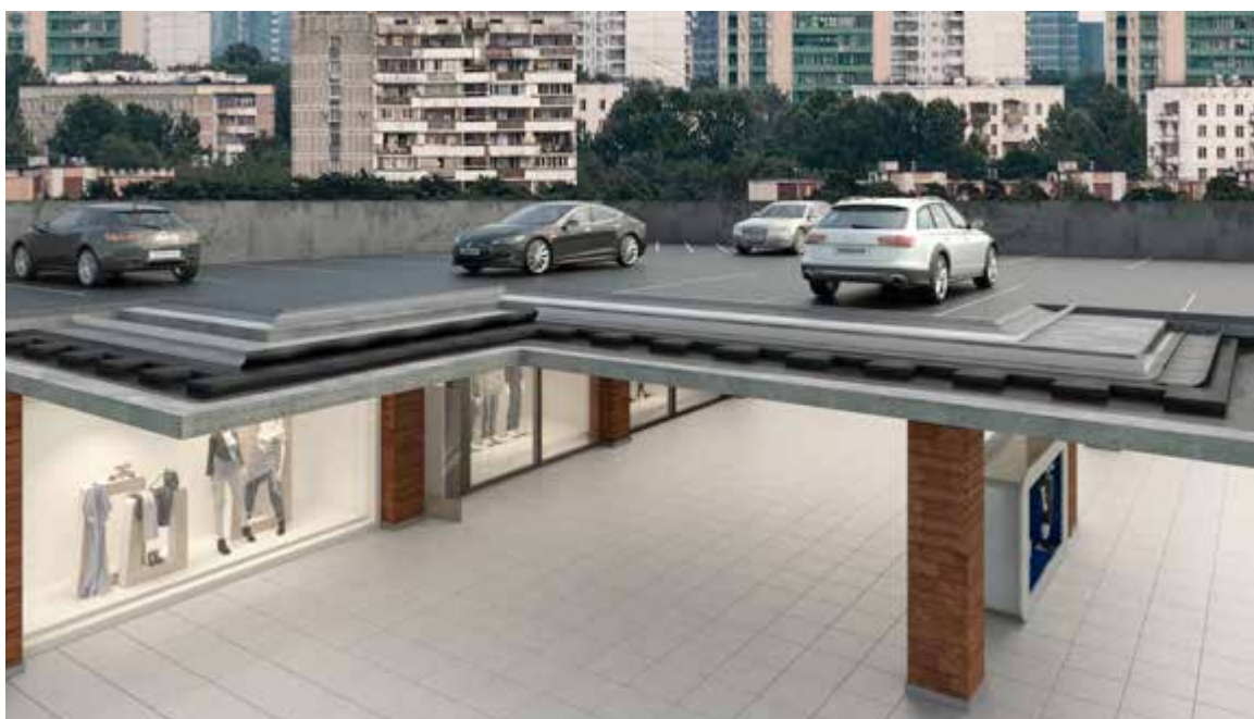
Image 3D de la structure d'une toiture-parking
